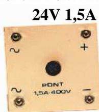
Pont de diode 1,5A. Les points repérés ~ (alternatif) sont à réunir à la source alternative (transformateur). Les points repérés + et - sont les sorties + et - du pont.
