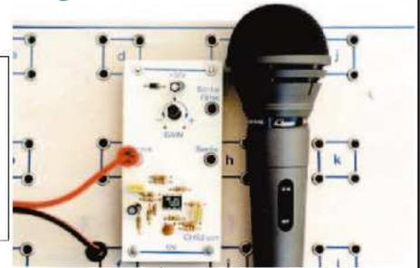
Le module CHS2 permet la visualisation du signal sur l'écran de l'oscilloscope.
