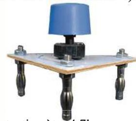
Potentiomètre 4,7k $\Omega$ . Variation de 0 à 4,7k $\Omega$  linéaire. Attention : Ne jamais réunir une alimentation entre une borne fixe du potentiomètre et le curseur (risque de destruction de la piste carbone par effet Joule lorsque le curseur est à proximité du point fixe).
