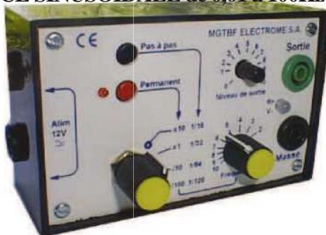
Sorties sur douilles bananes de sécurité. Alimentation sur bloc secteur. Dimensions : 87 x 57 x 30 mm. Livré complet avec notice et bloc secteur
