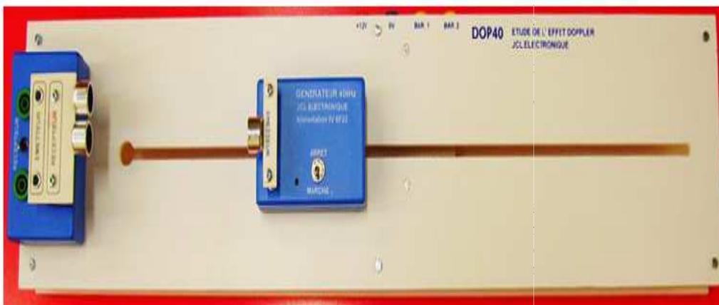
Comprend un générateur Ultra-sonique autonome (alimenté par pile fournie) équipé d'un transducteur émetteur, un boîtier récepteur avec transducteur émetteur supplémentaire, une plaque guide rainurée équipée de 2 barrières lumineuses, un écran avec guides.
