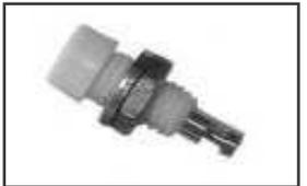
Intensité max. 5 A, isolant nylon 6 pans permettant un blocage idéal sur le chassis-Perçage chassis : 5,1mm (écrou non vissé). Existe en rouge, noir, bleu, vert, jaune et blanc (à préciser).
