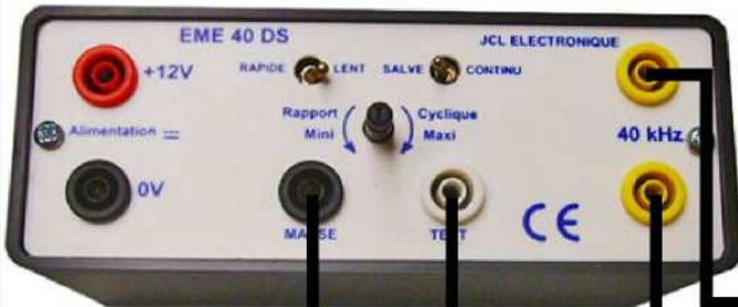
•La maquette ECHO40 comprend un générateur ultrasons EME40DS et un module Emetteur-Récepteur ECHO40ER.
